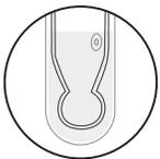
**Wieso?** Lagern im demineralisierten Wasser laugt Ionen aus der Glasmembrane und der Elektrolytlösung aus, was die Reaktionsfähigkeit verlangsamt und den Äterungsprozess beschleunigt.
