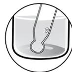
**Wieso?** Das Diaphragma der Referenzelektrode und die Glasmembrane der Messelektrode müssen beide komplett eingetaucht sein um den Kontakt mit der Probe zu gewährleisten.
